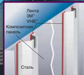
Отель «Джумейра Бич», Дубай, ОАЭ. Дизайн фасада: Schmidlin AG, 1998. Алюминиевые панели приклеены на стальные ребра жесткости
