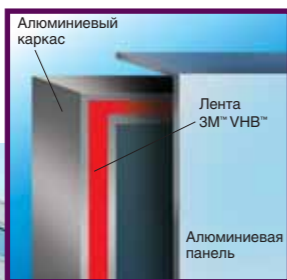
Плаза Центенарио, Сан-Паулу, Бразилия. Архитектор: Карлос Братке, 1995. Алюминиевые элементы жесткости приклеены к композитным панелям
