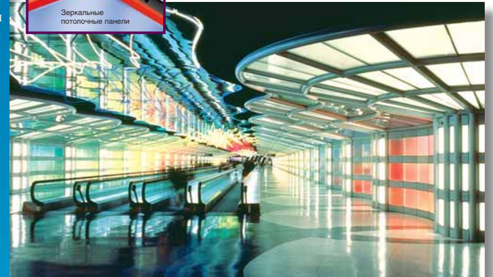
Аэропорт О'Харе, Чикаго, Иллинойс, США. Архитектор: «Кастом Продактс оф Саутгейт», Калифорния, 1987. Зеркальные потолочные панели из композита приклеены к подвесной раме
