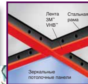
Аэропорт О'Харе, Чикаго, Иллинойс, США. Архитектор: «Кастом Продактс оф Саутгейт», Калифорния, 1987. Зеркальные потолочные панели из композита приклеены к подвесной раме
