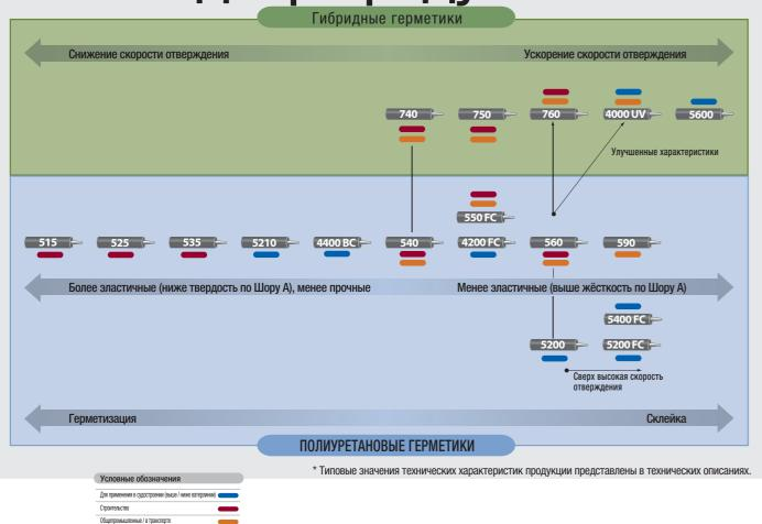
В данном разделе графически представлен диапазон применения полиуретановых и гибридных клеёв и герметиков ЗМ™. Не следует забывать о том, что скорость отверждения большинства клеёв и герметиков возрастает в условиях повышенной температуры и повышенной влажности. Учитывая это, компания ЗМ включила в ассортимент герметики с различным временем образования плёнки. Возможен подбор оптимального герметика для каждого производственного процесса с учетом климатических условий на производстве.
