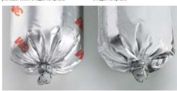
Обжатие концов колбас герметика ЗМ по сравнению с закреплением концов колбас проволокой способствует увеличению срока хранения герметика за счет предотвращения доступа внутрь упаковки влаги. В случае проникновения влаги внутрь упаковки может начаться прежлевременное отвержление материала, что приводит к его утилизации
